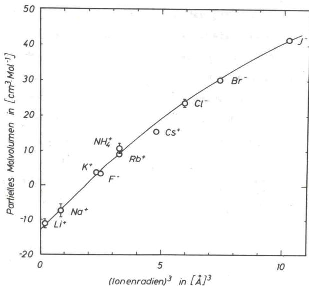
Abb. 33. Die von Zana und Yeager<sup>62)</sup> experimentell ermittelten partiellen Molvolumina einwertiger Ionen in Abhängigkeit vom Kristallvolumen der Ionen, das mit den Pauling-Radien berechnet wurde.
